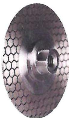
Алмазний диск 1A1R 125 Edge Dry M14. Диск для швидкісного різання керамограніту під кутом 45° з фланцем. Встановлюється на вал КШМ з виступом диску, що дуже зручно.
